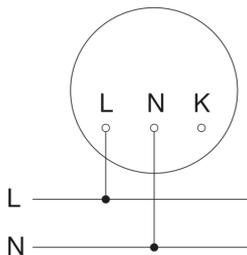
Schema elettrico Master-Master collegamento in rete
